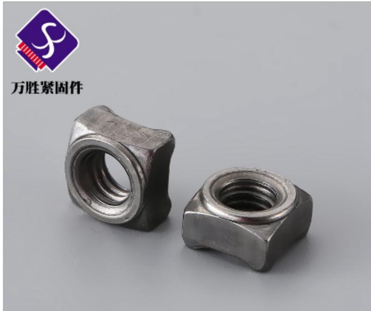
四方焊接螺母是螺母中的一种，使用的范围非常广，而且虽说焊接螺母的强度大，不易松脱，但在使用过程中还需要注意一些事项，以便焊接螺母连接使用。所谓焊接就是把两个分离件变成一个整体，用高温将金属融化后混合到一起在冷却，中间会加入合金，内部是分子力的作用，要比一般母体轻度大。四方焊接螺母在焊接前应该清理焊接部位的油渍、铁锈等污垢，以避免出现焊接气孔。应该使用纯度为99.99%的氩气作为保护气体，并且在电流情况为50-150A之间时，氩气流量应该达到8-10升每分钟，电流情况为150-250A之间时，氩气流量应该达到12-15升每分钟。四方焊接螺母的使用范围一般是焊接在6mm左右的薄板，这样能够避免焊接出现较大的变形，同时经过焊接后能够有较为美观的焊缝。在焊接时应该使用直流电，负极接在焊丝一头。螺母，就选温州万胜紧固件有限公司，用户的信赖之选，欢迎您的来电哦！浙江焊接螺母厂家
